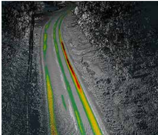
Figur A3.5 Eksempel på bruk av laserdata til å vurdere mulige årsaker til sporutvikling pga. manglende drenering. Midt i bildet sees en bergknaus som sannsynligvis leder vann inn i vegkroppen og forårsaker spordannelse (mørkere farge = dypere spor). [35]
