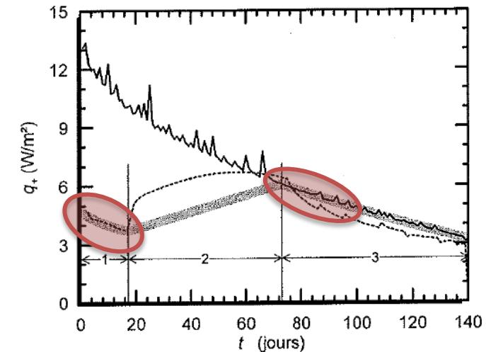
Figure 12. Modèle simplifié du flux thermique sous le front de gel pour une route isolée thermiquement.
